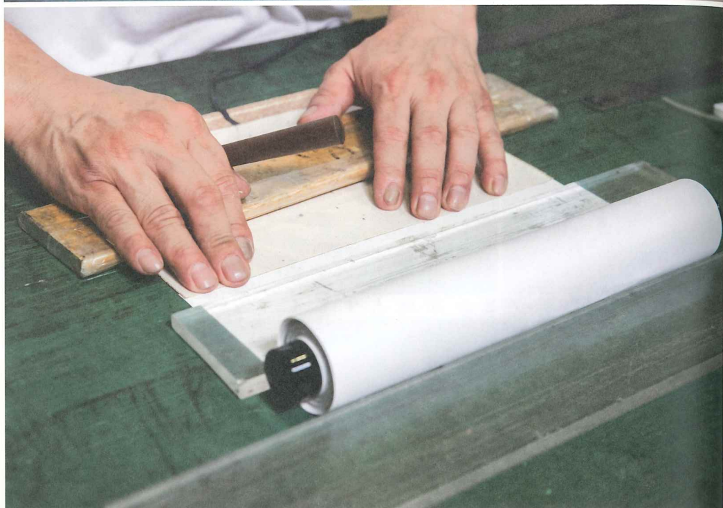
（上）高速道路の路線図を折り地図に仕立てる。蛇腹折りの実演を見せてくれた職人の小暮さん。
